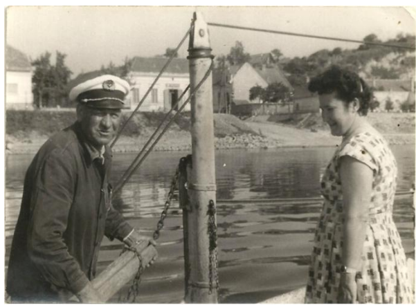
Fent: id. Magyarosi Mihály révész a vontatott kompot kormányozza a hátsó evezővel, a lentával . Erre az evezőre a kikötéseknél volt különösen nagy szükség. (1960-as évek második fele. Rádócziné Csányi Katalin gyűjteményéből.)
